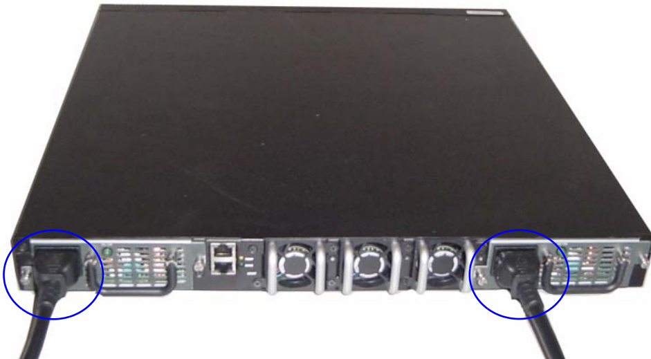
Abbildung 2. Anschließen der Netzstromkabel
